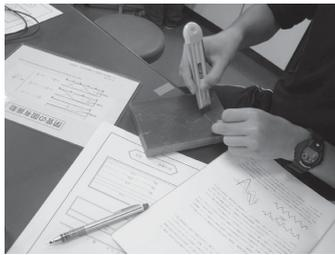
(b) エナメル線の両端を鉄の爪で削る
